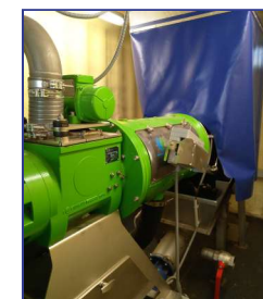
Сепарування (розділення) гною на тверду і рідку фракції з подальшою пастеризацією і використанням твердої фракції для підстилки, а рідкої для добрива
