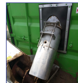
Сепарування (розділення) гною на тверду і рідку фракції з подальшою пастеризацією і використанням твердої фракції для підстилки, а рідкої для добрива
