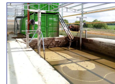
Сепарування (розділення) гною на тверду і рідку фракції з подальшою пастеризацією і використанням твердої фракції для підстилки, а рідкої для добрива
